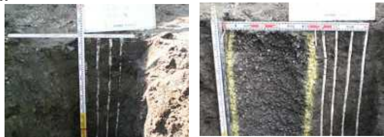
(i)無補強地盤 (ii)補強地盤
