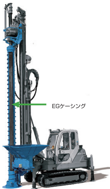
エコジオ地盤改良機
